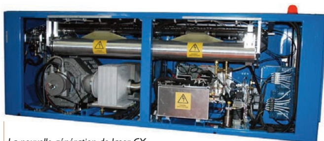
La nouvelle génération de laser CX du Groupe Prima est une famille de lasers industriels à flux axial rapide, à excitation continue, basée une grande expérience des sources CO2. Cette gamme est l'évolution du modèle CP et en reprend la conception compacte et le concept d'économie d'énergie intégré.
