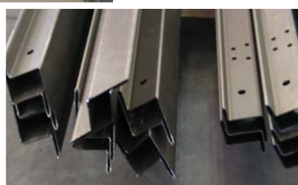
Esempi di porte con relativi telai realizzati da MBM. Si noti il preciso lavoro di piegatura della lamiera precedentemente tagliata con il laser
