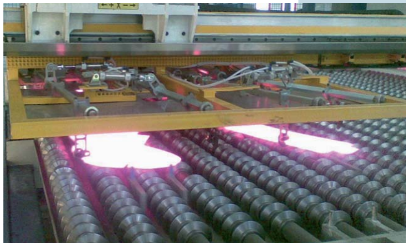
FIG|03 Visione dei componenti tranciati all'interno di un forno che li porta ad una temperatura di 930 °C.
