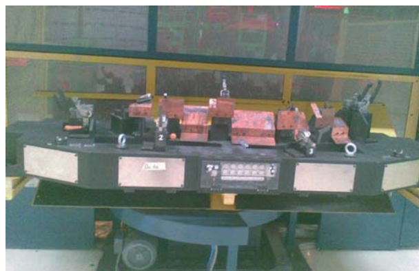
FIG06 Ogni unità Rapido utilizza una tavola rotante a due stazioni con dispositivi automatici di bloccaggio dei componenti da rifilare.
