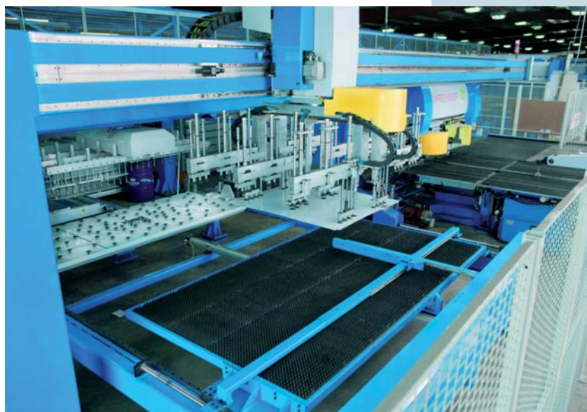
FIG|03| L'unità PSBB integra in modo flessibile varie esigenze della produzione industriale: la punzonatrice è qui un vero centro di lavoro per lamiera.
