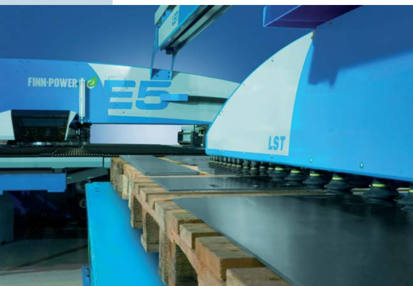
FIG|04 | Punzonatrice servoelettrica a torretta con gestione automatica della lamiera.
