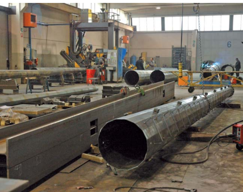
FIG|04 Pali per illuminazione prodotti da Gualini Lamiere: a sinistra, la realizzazione (foto Prima Industrie). A destra, la messa in opera (foto Gualini).
