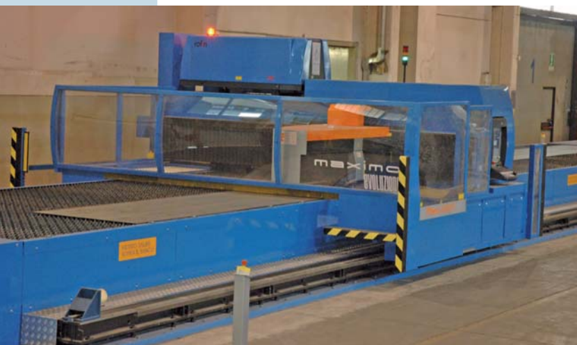
FIG 07 Il sistema Maximo Evoluzione di Prima Industrie è costituito dalla tradizionale e ben collaudata unità Platino (che opera con elevate dinamiche su un campo di lavoro di 3000 x 1500 x 150 mm) in moto coordinato sulle lunghe vie di corsa (20.000 mm) dell'asse Y2 (foto Prima Industrie).
