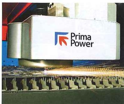
Durch die Parallel-Kinematik-Struktur des Schneidkopfes und die besondere CNC-Steuerung erreicht die Synchrono selbst bei so komplexen Bahnkurven wie dem Muster der 8.000 Löcher der Fackel extrem hohe Geschwindigkeiten.
