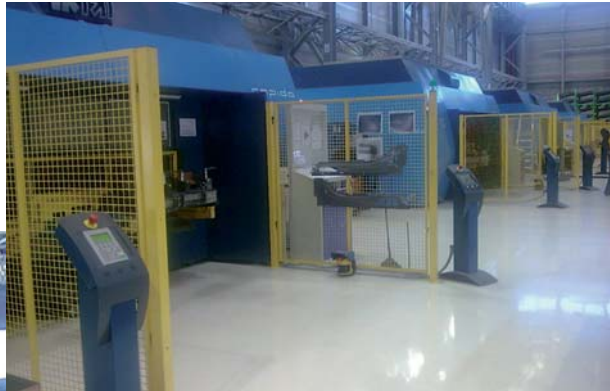
FIG05 Quattro sistemi laser Rapido per la rifilatura dei componenti stampati a caldo. Ogni unità è alimentata da una sorgente a CO 2 avente potenza di 4 kW.
