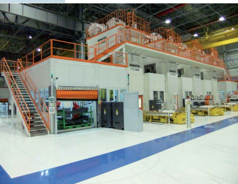
FIG 04 Linea di presse meccaniche per la rifilatura e foratura automatica dei componenti stampati a caldo.
