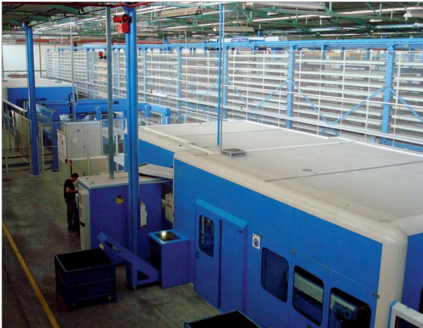
Il magazzino Night Train di Finn Power serve da buffer per permettere alle piegatrici di lavorare, presidiate, su due turni invece di tre.
