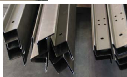
Esempi di porte con relativi telai realizzati da MBM. Si noti il preciso lavoro di piegatura della lamiera precedentemente tagliata con il laser
