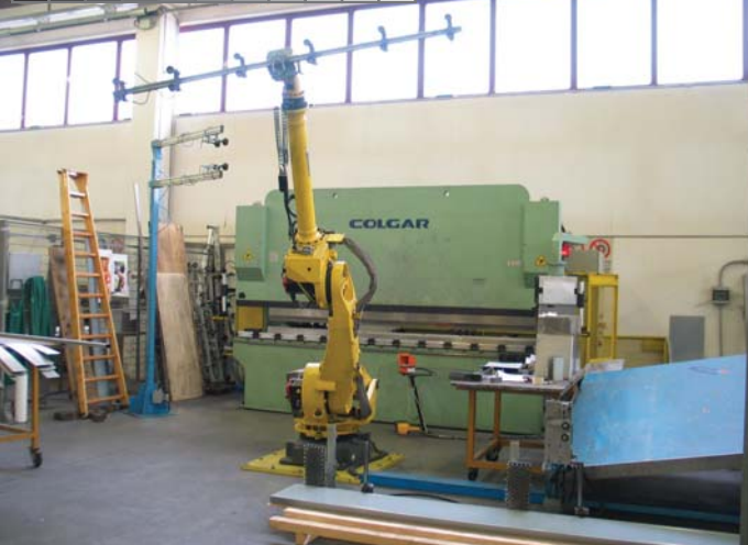
Piegatrice Colgar, con sistema di movimentazione robotizzata della lamiera, installata presso la società MBM
