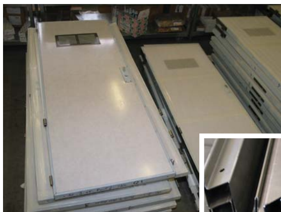
Esempi di porte con relativi telai realizzati da MBM. Si noti il preciso lavoro di piegatura della lamiera precedentemente tagliata con il laser
