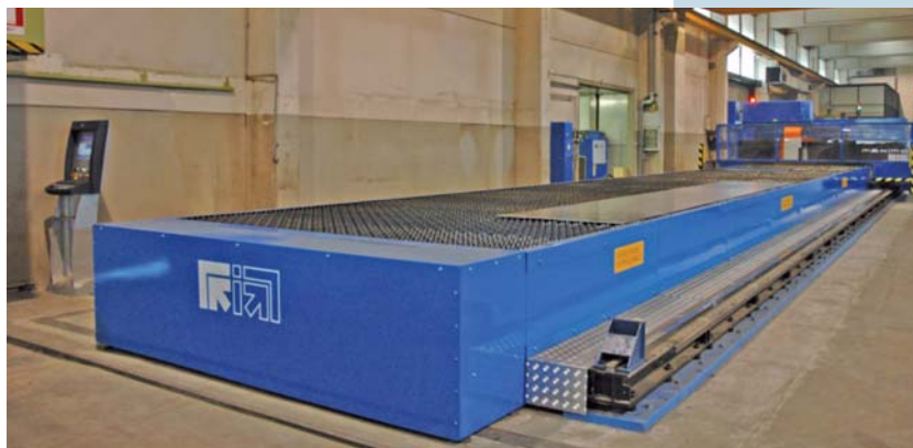
FIG 06 Vista d'insieme del sistema Maximo Evoluzione di Prima Industrie installato presso Gualini Lamiere. Il campo di lavoro complessivo di questo sistema è di 3000 x 20.000 x 150 mm (foto Prima Industrie).
