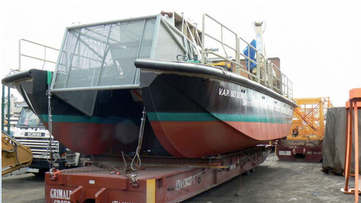
FIG|03 | Draga per porti realizzata da Gualini Lamiere (foto Gualini).
