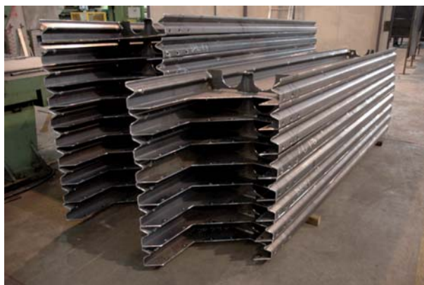
FIG|02| Elementi delle barriere foniche realizzate da Gualini Lamiera per l'autostrada Chiasso Lugano (foto Prima Industrie) e vista complessiva delle barriere progettate dall'architetto Botta (foto Gualini).
