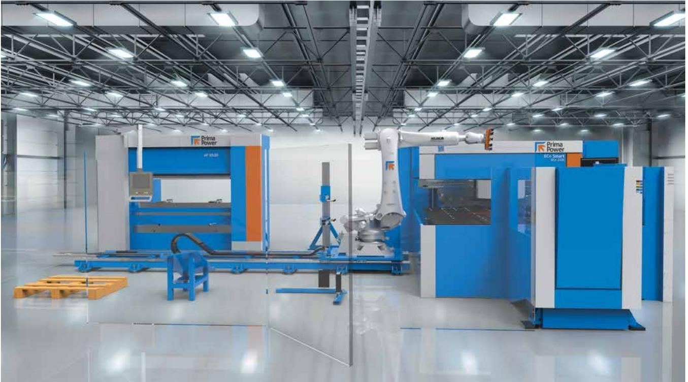
Le macchine pannellatrici, piegatrici e punzonatrici sono passate da una tecnologia idraulica ad una di tipo servo-elettrico.
