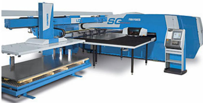
Figura 4 – Esempio di Shear Genius con sistema automatico di carico LD
