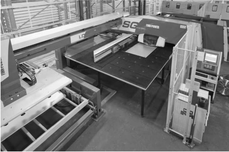
Figura 4 – Esempio di Shear Genius con sistema automatico di carico LD
