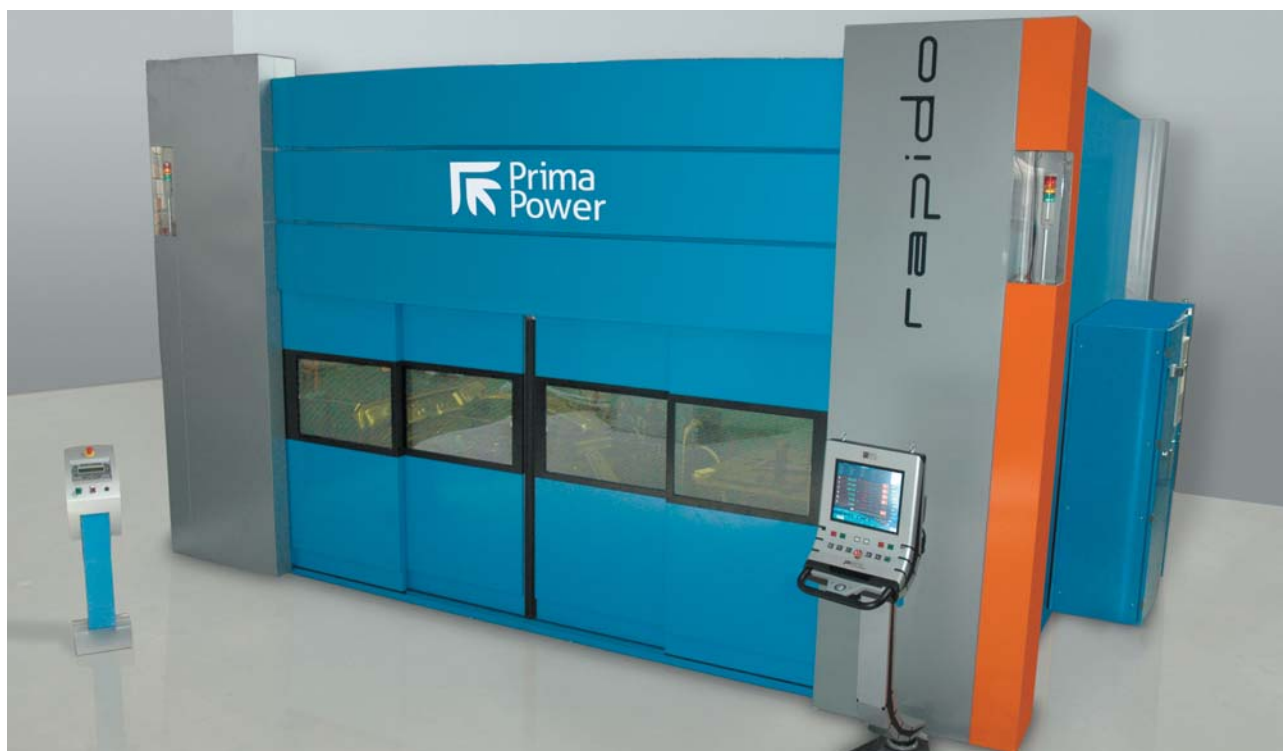
RAPIDO EVOLUZIONE2 EQUIPPED WITH FIBER LASER
