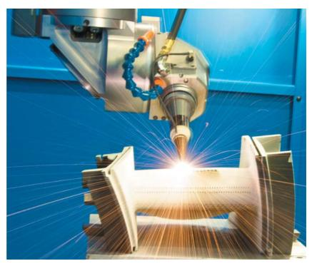
BEAMDIRECTOR BY LASERDYNE DRILLING A NOZZLE GUIDE VANE
